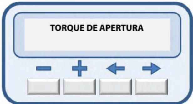
Para aumentar el torque de apertura, presione la tecla (+) hasta el nivel de torque deseado y para disminuirlo, presione la tecla (-).
