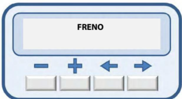
Para aumentar el nivel de freno, presione la tecla (+) y para disminuirlo, presione la tecla (-).
