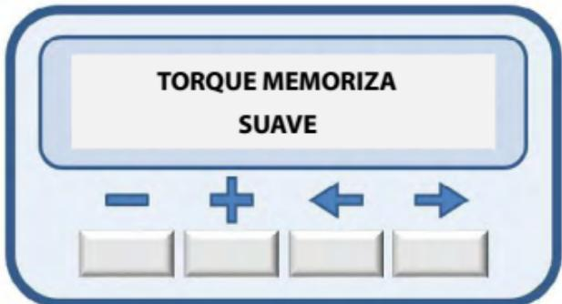
Permite cambiar la memorización del torque del recorrido grabado seleccionando a través de las teclas (-) o (+) las opciones suave, moderado o fuerte.
