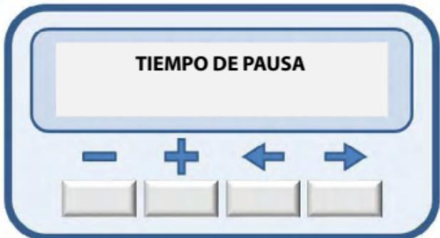
Para aumentar el tiempo automático, presione la tecla (+) y para disminuirlo, presione la tecla (-).
