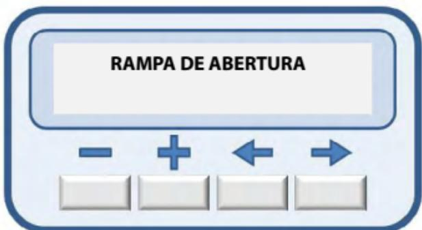
Para aumentar a rampa de abertura basta pressionar a tecla (+) e para diminuir basta pressionar a tecla (-).
