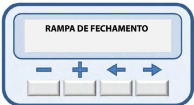
Para aumentar a rampa de fechamento basta pressionar a tecla (+) e para diminuir basta pressionar a tecla (-).
