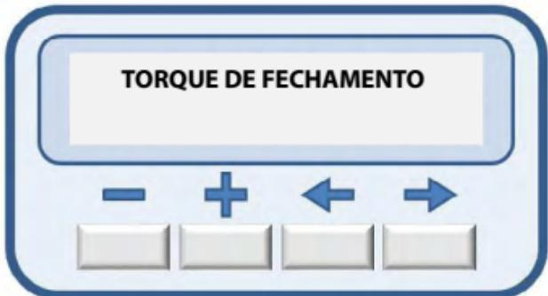
Para aumentar o torque de fechamento basta pressionar a tecla (+) até o nível de torque desejado e para diminuir basta pressionar a tecla (-).
