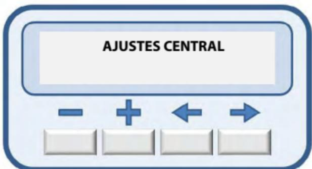
El ajuste de fábrica sale como permitido. Para bloquearlo, presione y suelte la tecla (+) y para desbloquearlo, presione y suelte la tecla (-).
