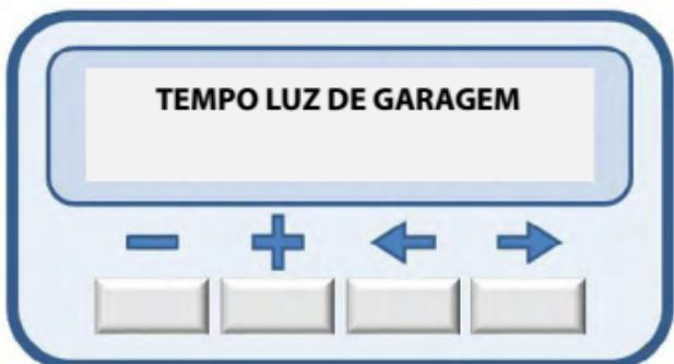
Para aumentar o tempo de luz de garagem basta pressionar a tecla (+) e para diminuir basta pressionar a tecla (-).
