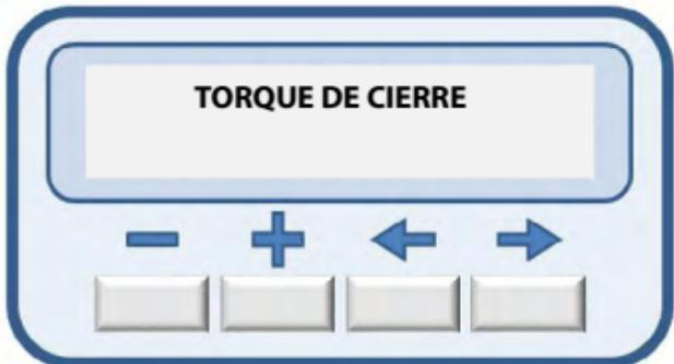
Para aumentar el torque de cierre, presione la tecla (+) hasta el nivel de torque deseado y para disminuirlo, presione la tecla (-).
