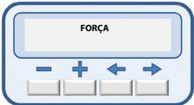
A força sai de fabrica no nível máximo, para diminuir basta pressionar a tecla (-) ate o nível desejado, para aumentar basta pressionar a tecla (+).
