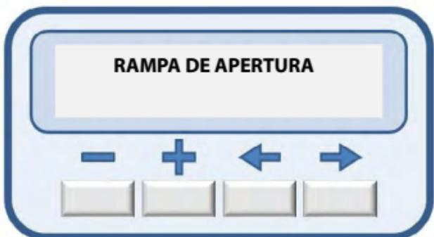
Para aumentar la rampa de apertura, presione la tecla (+) y para disminuirla, presione la tecla (-).
